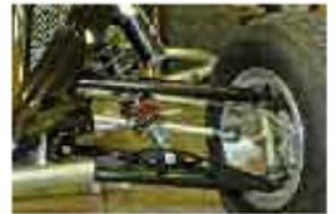
Eicker-A-Arms: geführt von WP-Federelementen, für deren Einbau (unten) zwei Positionen zur Verfügung stehen
